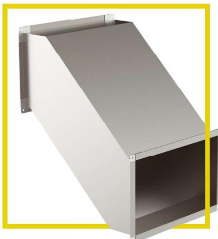
Z-образный переход служит для огибания препятствий, расположенных на трассе воздуховода в вентиляционной системе, например, в случае пересечения вентиляционных каналов. Переход на концах имеет фланцы и усилен поперечной гофрировкой стального листа. С целью достижения определенного воздушного потока рекомендуется применять соответствующие значения длины L и отклонения E, при которых угол поворотов потока в утке будет составлять 30° или 45°.
