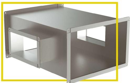
Крестовина на концах имеет фланцы и усиlena поперечной гофрировкой стального листа. Крестовина дает возможность проведения монтажа вентиляционной системы с ответвлениями под углом 90 градусов.
