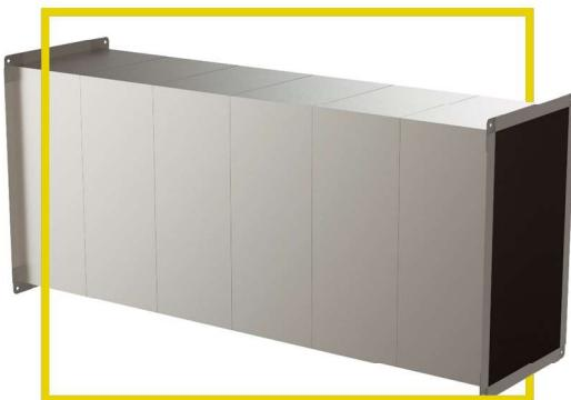
Прямоугольный вентиляционный канал на концах имеет фланцы и укреплен поперечной гофрировкой стального листа. Дополнительно, в зависимости от размеров, канал укреплен трубчатыми оцинкованными ребрами жесткости.
