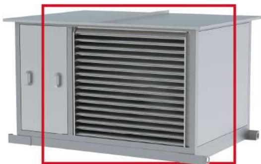
■ обеспечивают прямую подачу наружного воздуха с надкровельного пространства в лестничные и лифтовые зоны, создавая избыточное давление в лестничных, лифтовых и прочих зонах, не допуская поступление дыма в эти помещения. При этом упрощается вентиляционная система и освобождается рабочее пространство на техническом этаже.
