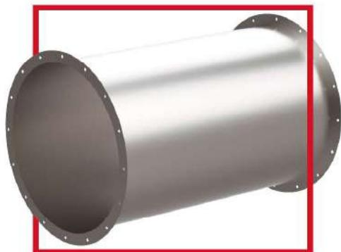
Прямой участок воздуховода OZA-PUV используется при монтаже осевых вентиляторов в вентсистемах. Установка прямого участка особенно необходима перед вентилятором при наличии фасонных элементов во входных участках воздуховодов, а также за выходным сечением осевого вентилятора без спрямляющего аппарата.
