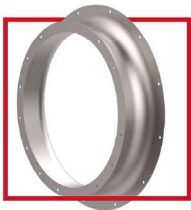
Входной коллектор OZA-VKO служит для правильного формирования равномерного поля скоростей при входе потока на лопатки колеса вентилятора серии OZA при работе без сети на входе. OZA-VKO должен обязательно устанавливаться также на всасывающий воздуховод при последующей установке вентилятора, т.к. при фланцевом входе потока в осевой вентилятор или воздуховод происходит значительное снижение расхода и создаваемого давления вентилятора из-за потерь на кромке фланца.
