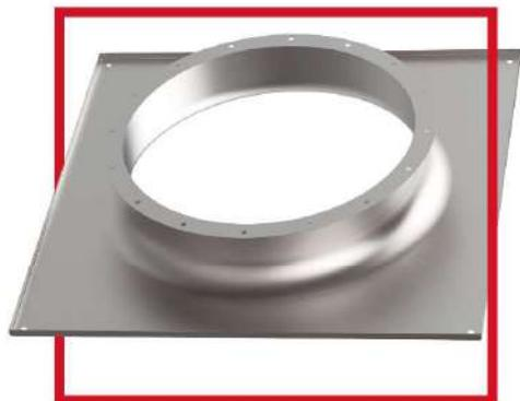
Переходник крышный OZA-PEK служит для формирования равномерного поля скоростей при входе потока на лопадки колеса вентилятора.
