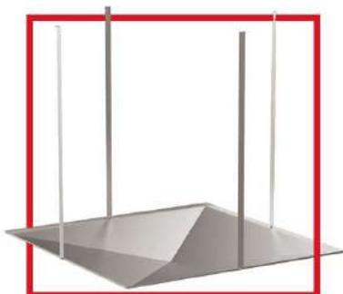
Для сбора и удаления конденсата, образуемого на границе влажного воздуха уходящего из помещения и холодных металлических частей вентилятора и/или монтажного стакана STAM, обязательна установка поддона POD, особенно на ответственных объектах (склады, операторные, силовые подстанции). В помещениях с сухим режимом применение POD рекомендуется для защиты от экстремальных дождевых осадков.
