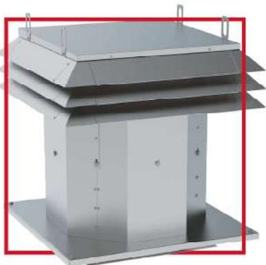
обеспечивают прямую подачу наружного воздуха с надкровельного пространства в лестничные и лифтовые зоны, создавая избыточное давление в лестничных, лифтовых и прочих зонах, не допуская поступление дыма в эти помещения. При этом упрощается вентиляционная система и освобождается рабочее пространство на техническом этаже.
