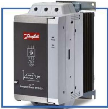
Пристрої плавного пуску - софт-стартери - це електронні прилади, які регулюють напругу, що подається на двигун, забезпечуючи при цьому плавне збільшення/зменшення швидкості двигуна в моменти пуску і гальмування. Застосовуються пристрої плавного пуску VLT® MCD компанії «Danfoss».
