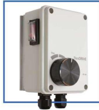
Регулятор швидкості обертання вентилятора призначений для регулювання продуктивності вентиляторів шляхом зміни напруги живлення (зміна швидкості обертання). Обероти двигуна регулюються поворотом ручки (потенціометром) на лицьовій панелі корпусу.
