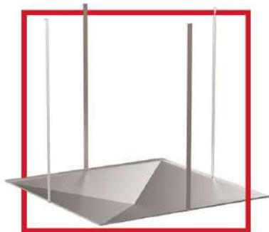
Для збору і видалення конденсату, що утворюється на кордоні вологого повітря, що виходить з приміщення і холодних металевих частин вентилятора і/або монтажного стакана STAM, обов'язкова установка піддона POD, особливо на відповідальних об'єктах (склади, операторні, силові підстанції). У приміщеннях з сухим режимом застосування POD рекомендується для захисту від екстремальних дощових опадів.
