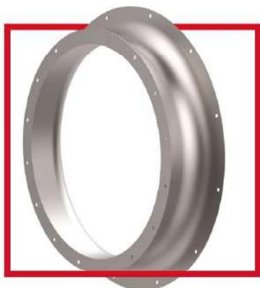
Вхідний колектор OZA-VKO призначений для правильного формування рівномірного поля швидкостей при вході потоку на лопатки колеса вентилятора серії OZA при роботі без мережі на вході. OZA-VKO повинен обов'язково встановлюватися також на всмоктуючий повітровід при подальшій установці вентилятора, тому що при фланцевому вході потоку в осьовий вентилятор або повітровід відбувається значне зниження витрати і створюваного тиску вентилятора через втрати на кромці фланця.
