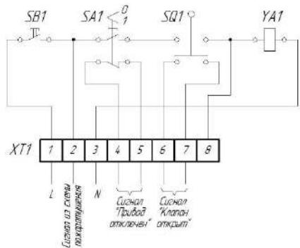
Рисунок 7 - Схема електричних з'єднань виконавчого механізму з електромагнітом
