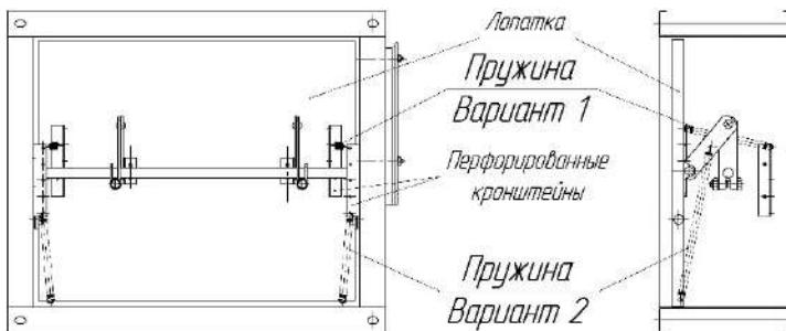
Рисунок 6 - Варіанти встановлення пружин
