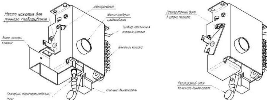
Рисунок 5 - Місця регулювання виконавчого механізму з магнітом
