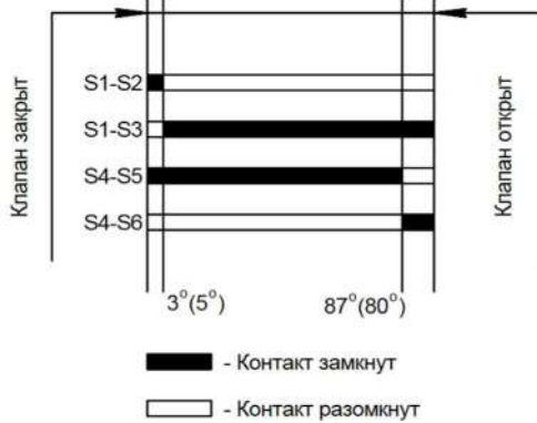
Рисунок 6 - Рекомендована схема включення клапанів KPU та сигналізації
