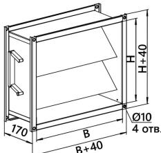
Рисунок 1 - Загальний вид клапана типу KP-FDS-REG
