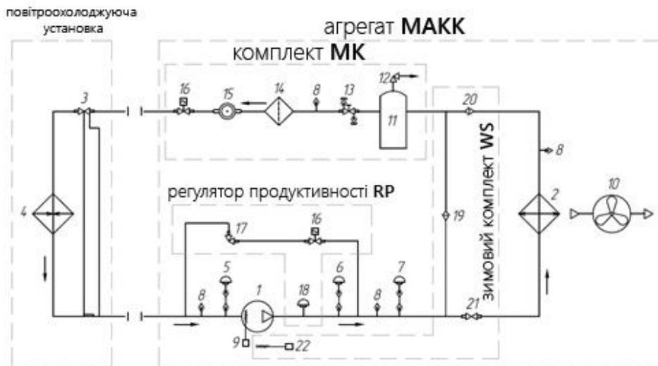
Рисунок 10 - Функціональна схема холодильної машини на базі агрегату компресорного МАКК з опціями
