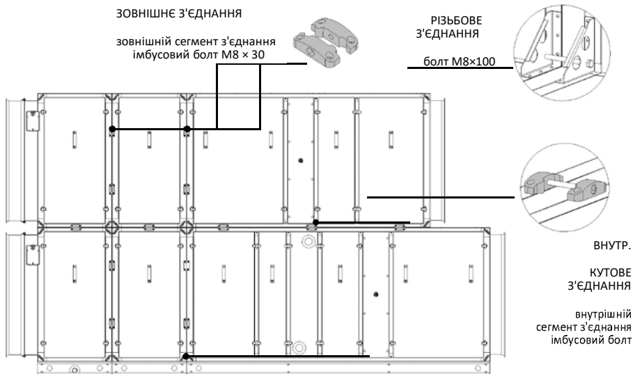
Рисунок 4. Приклад з'єднання секцій кондиціонера VRS з пластинчастим теплоутилізатором.
